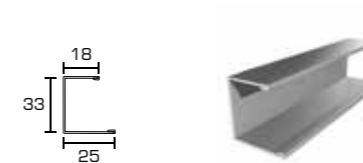
PROFILO/PROFILE "C" 18x33x25 L=4000mm PER STRUTTURA NASCOSTA / FOR HIDDEN STRUCTURE
